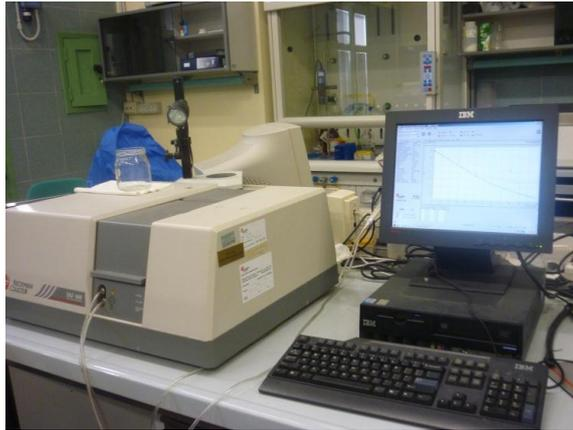
Fig.3.4. Spettrofotometro Beckman Coulter, DU 800 Spectrophotometer.
