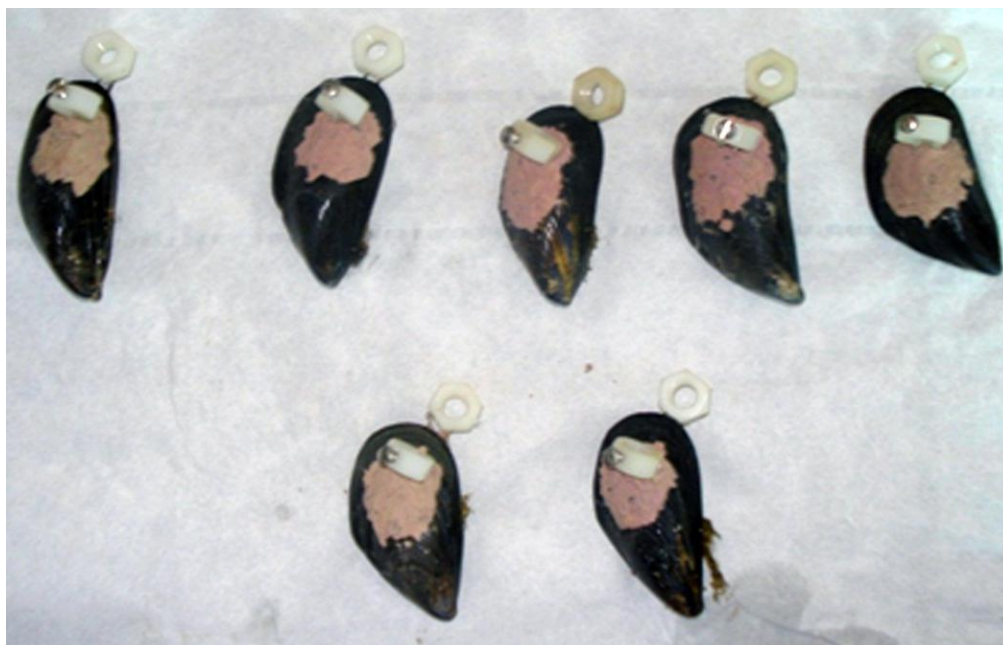
Figura 13: Mitili con attacco per i sensori. Nel dado posizionato in alto veniva sistemato un bullone contenente in magnete, mentre l’altro posizionato al centro è stato utilizzato per il sensore che veniva poi bloccato in posizione da una vite inox.
