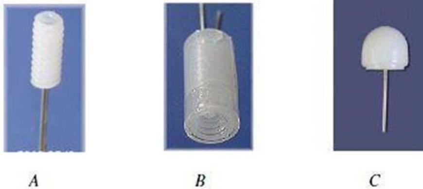
**Figura 15:** *A) cannula guida; B) push pull; C) dummy cannula*
