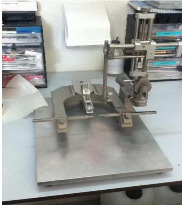
*Figura 16: Apparecchio stereotassico utilizzato in laboratorio*
