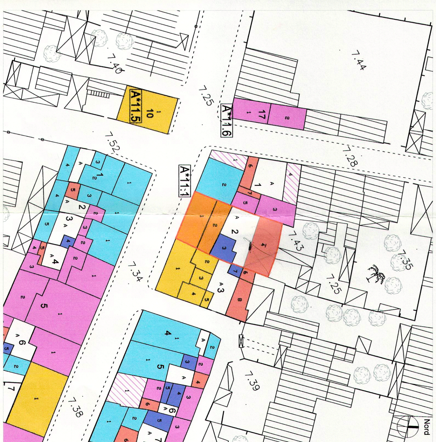
P. P. zona A* - Isolato A*11.1 - Unità Edilizia n. 2 - Tavola 10 "Interventi" - Situazione Proposta scala 1:500
